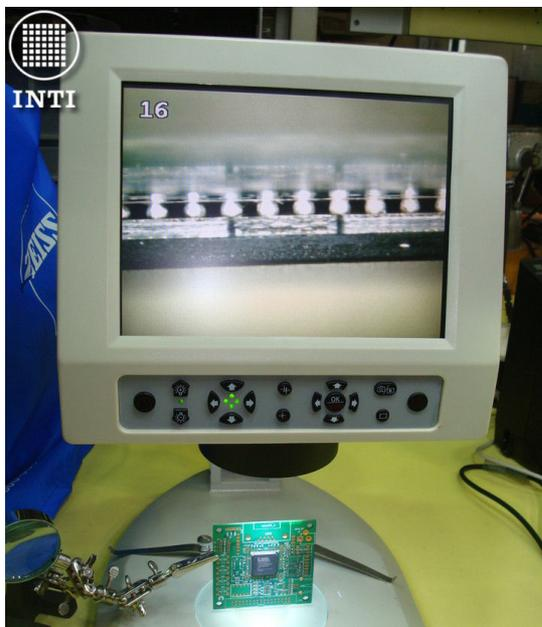
Figura 6. Microscopio digital utilizado para inspección del nivel exterior.
