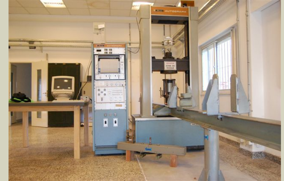
Modernización con GNU/Linux de un equipo de ensayos para maderas
