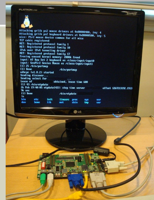
GNU/Linux y BusyBox corriendo sobre LEON3/Glib, usando una placa FPGA comercial.
